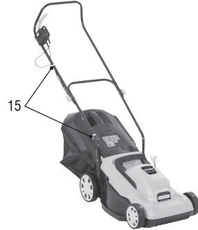
Figura 10 – Fije el cordón eléctrico, con las grampas (15)
