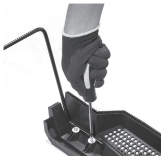
Figura 4 – Prenda a haste metálica
